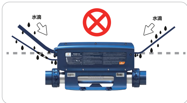
控制系统连接电线错误展示，如上图所示
